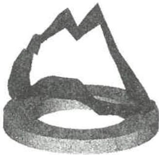
Fig. 3 Modelul spațial al abaterii de la planitate (scara pentru abaterea 250:1).
