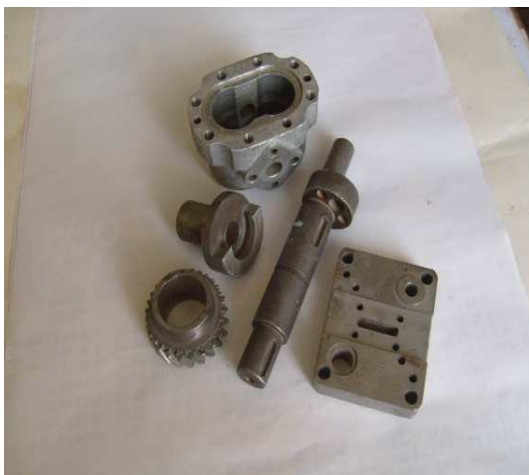
Fig. 1. Piese cu suprafețe de contact uzate
